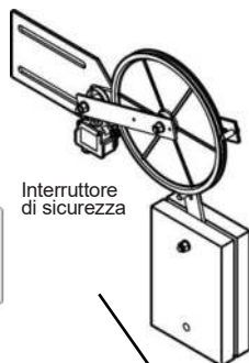
Fig. 2 Limitatore di velocità Mod. LK120/ LX120/LX150/LX200/LX180/LK200/ LK250/ LK300/LK315 con comando a distanza
